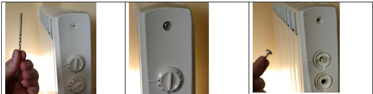
Maintenant enlever le côté en plastique du radiateur pour avoir accès au thermostat électronique.
